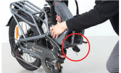
배터리의 키를 돌려줍니다. (배터리 낙하 주의)
