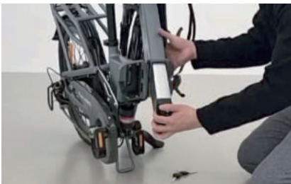
키를 돌려해주는 순간 배터리가 기체밖으로 내려옵니다. 배터리를 잡으면서 배터리의 키를 돌려주세요.
